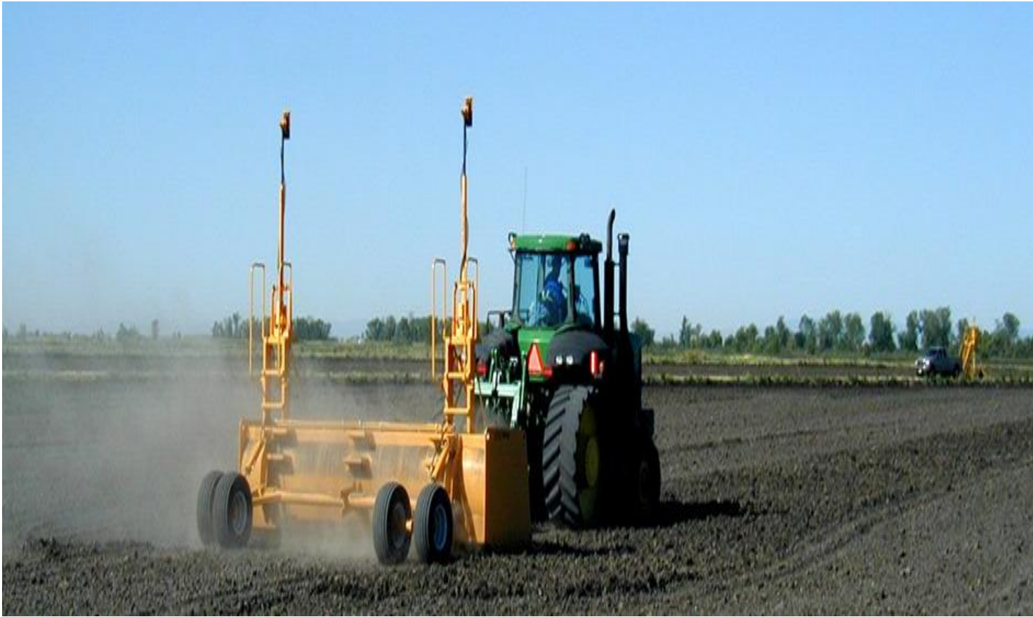
Hệ thống máy san phẳng đồng ruộng định vị bằng tia laser.
